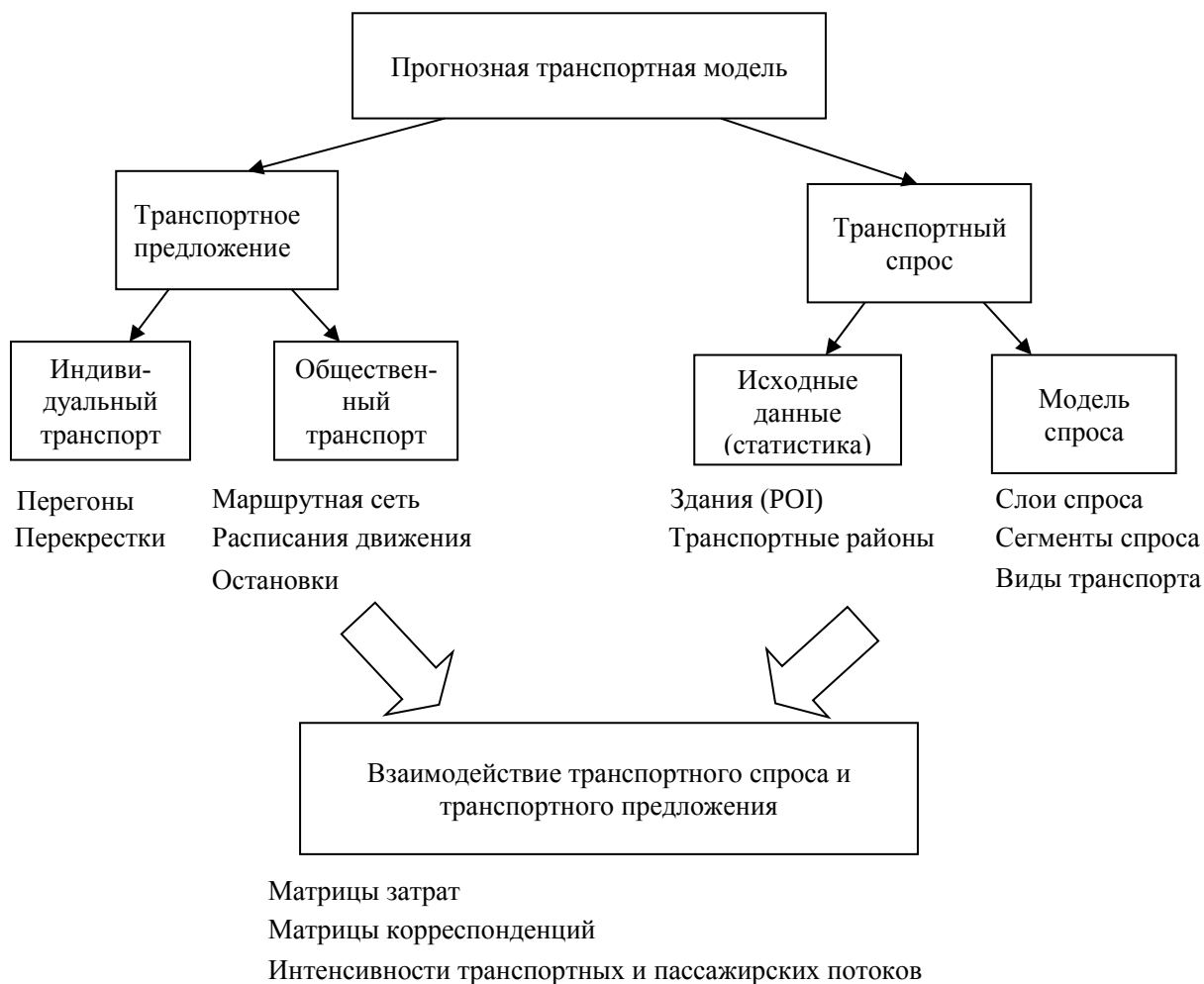
Рис. 5.2. Структура основных составляющих прогнозной транспортной модели Города Томска
