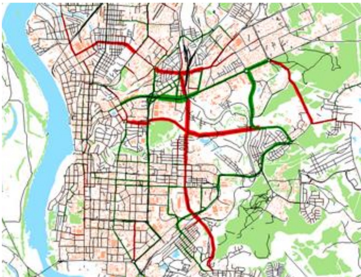
Рис. 6.4. Изменение интенсивностей движения транспортных потоков на УДС Города Томска к 2035 году при реализации Программы
